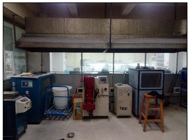
左、右图：金旭源项目的真空倒模机、真空铸造机。
